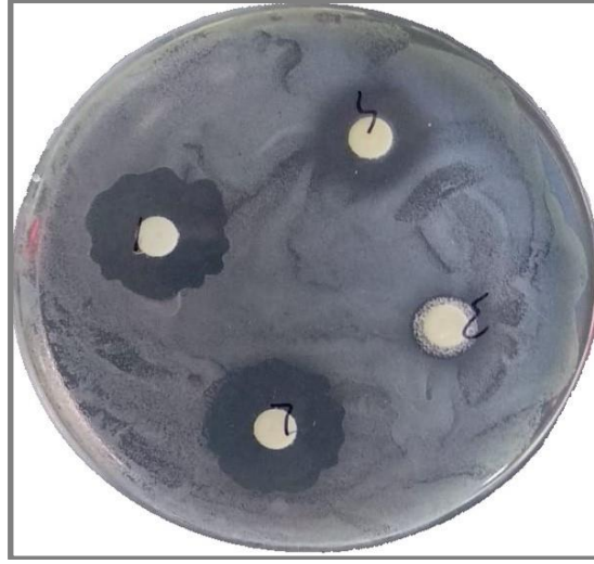
Şekil 3.15. Disklere emdirilen maddelerin (A bileşigi etanol (1), B bileşigi etanol (2), A bileşigi DMSO (3) B bileşigi DMSO'da (4) çözülerek hazırlandı) E. faecalis üzerinde oluşturdukları inhibisyon zonları
